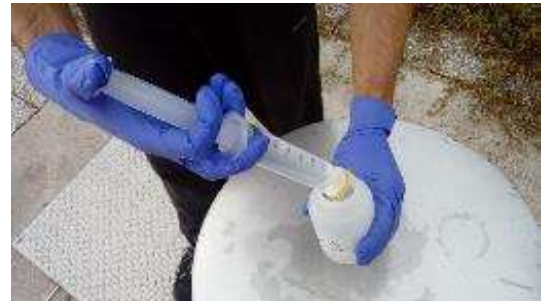
Vorbereitung von Grundwasserproben im Feld
