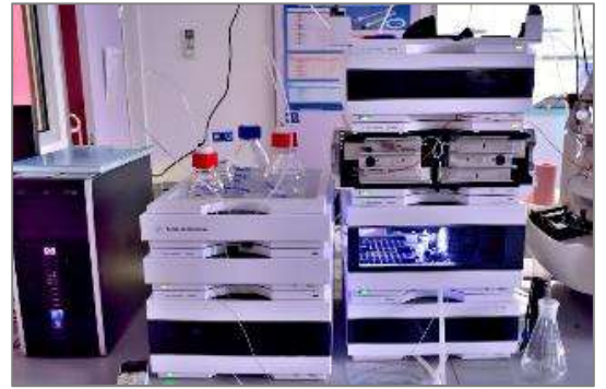
Flüssigkeitschromatograph zur Bestimmung von Medikamentenrückständen in Wasserproben
